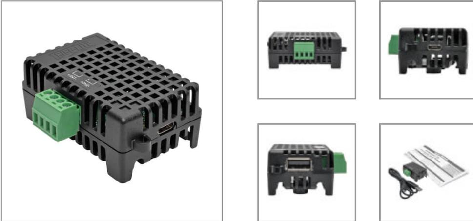
Monitoree condiciones de temperatura y humedad ambiente, así como estados de alarma por cierres de contacto, productos de seguridad y telecomunicaciones.
