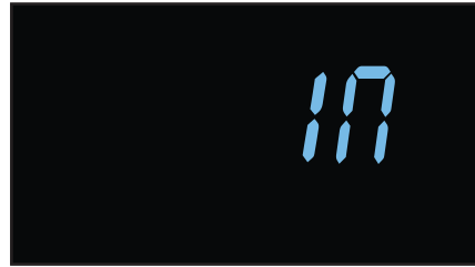
IN ( Batería Interna)
