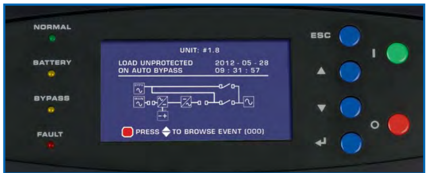
Le panneau de contrôle à LED et LCD fournit des informations détaillées sur l'état de l'onduleur.
